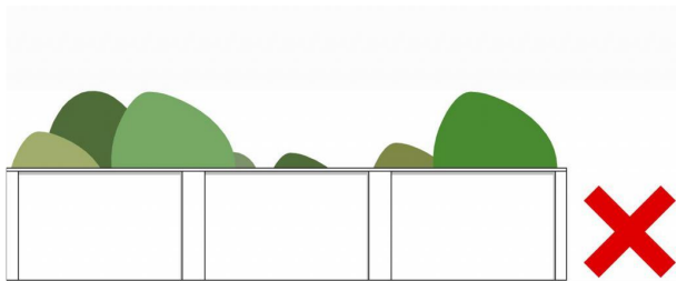
A falszerű áttörés mentes kerítések nem elfogadhatóak.
